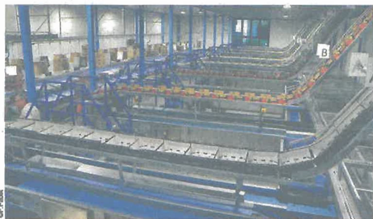
La station de conditionnement de cerises et d'abricots de la SARL 'Grand Hôpital' présente une capacité de traitement de 2,5 tonnes/heure.
